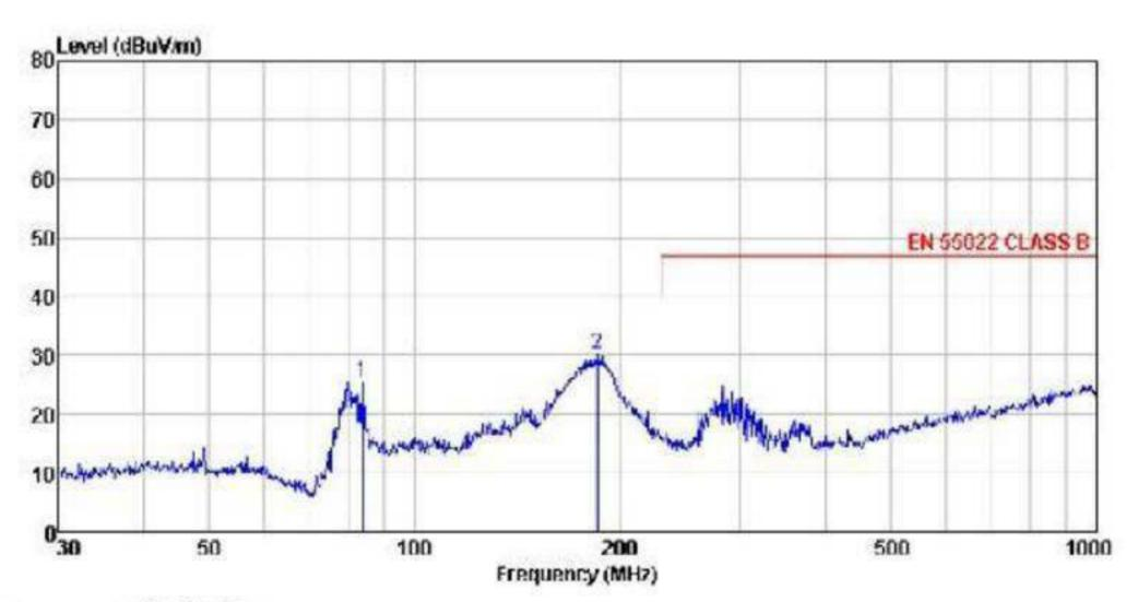
Site : 3m chamber Condition : EN 55022 CLASS B 3m VULB9163-2013M HORIZONTAL EUT :
